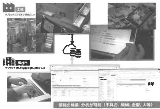
第3図 金型IoT：金型電子カルテと金型QR・タブレットによる金型保全現場
