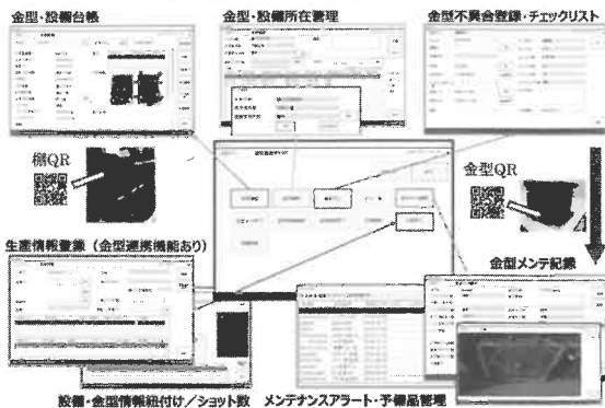
第3図 金型IoT：金型電子カルテと金型QR・タブレットによる金型保全現場
