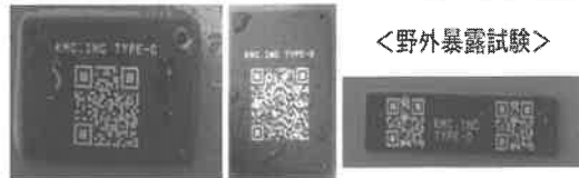
第2図 QR銘板の仕様とサンシャインウェザーメーターによる耐候性試験結果
