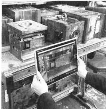
金型に金属製の「QR銘板」を取り付けて管理する
