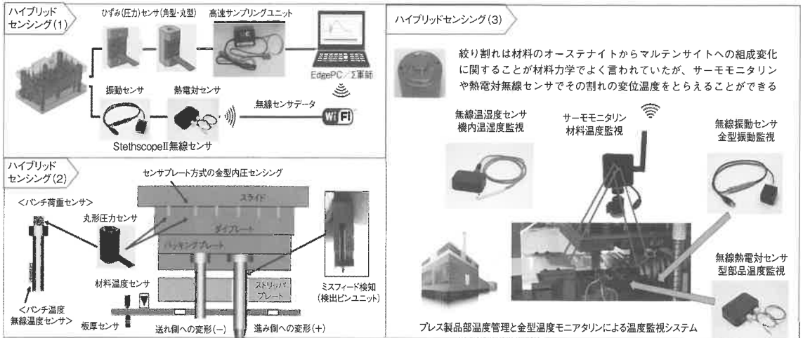
図3 半導体ひずみセンサ「プレスモニタリン」と様々なセンサと連携したハイブリッドセンシング例
