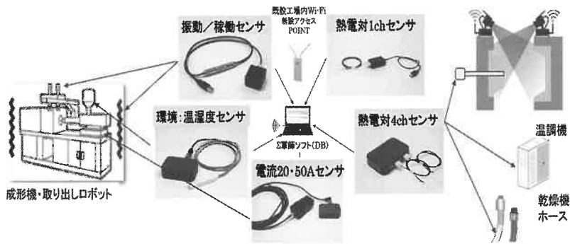
第7図 Stethoscope IIのラインアップと成形装置・金型への適用
